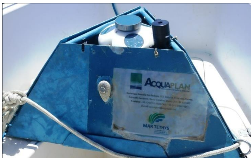
Figura 9. Equipamento AWAC® utilizado no fundeio já fixado em estrutura piramidal.
